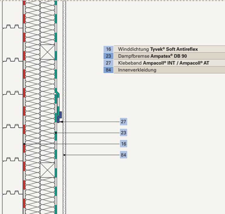
Folgende Klebprodukte sind geeignet zur Anwendung auf Tyvek® Soft Antireflex:
