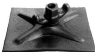
Die Flügelmutter und die Unterlagsplatte bilden eine unverlierbare Einheit. Kein Neigungsausgleich wie bei der Kalottenplatte möglich; Tragkraft für Stahlgurtungen 90 kN; Tragkraft für Holzgurtungen je nach Aufstandsfläche und zulässiger Flächenpressung 20-50 kN.
