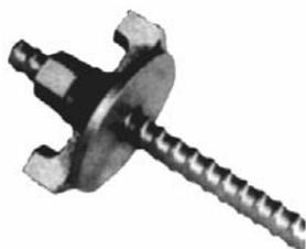
Ankerflügelmutter mit Abstandsscheibe für übergreifende Auflagerungen auf Gurtungen. Tragkraft 90 kN.
