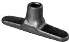
Schmiedestück für den Stirnflächenanschluss der Ankerstäbe an Stahlkonstruktionen, z.B. bei einhäutiger Wandschalung mittels Schweissnaht; a = 4 mm, L > 2x100 mm
