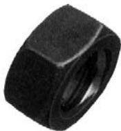
Je nach Höhe der Mutter nur als Kontermutter (h = 30 mm) oder als Anker Mutter (h = 50 / 70 mm) verwendbar; Tragkraft bei h = 30 mm 50 kN; Tragkraft bei h = 50 / 70 mm 90 kN.
