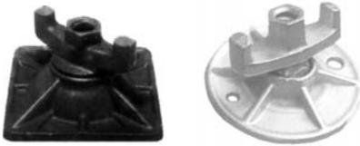
Zur Verankerung von schräg durch die Schalung geführten Ankerstäben. Die Flügelmutter ist kugelig und unverlierbar in der Druckplatte verankert; Tragkraft für Stahlgurtungen 90 kN; Tragkraft für Holzgurtungen je nach Aufstandsfläche und zulässiger Flächenpressung 20-50 kN.
