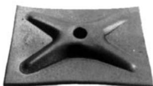
In Verbindung mit der Flügelmutter dient sie zur Lastabtragung aus dem Ankerstab bei Holz- und Stahlgurtungen; Tragkraft für Stahlgurtungen 90 kN; Tragkraft für Holzgurtungen je nach Aufstandsfläche und zulässiger Flächenpressung 20-50 kN.
