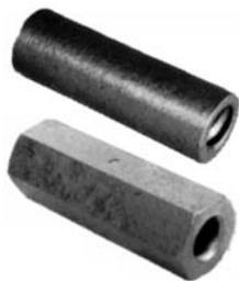
Element zum Verbinden zweier Ankerstäbe; Einschraub sicherheit durch Mittelstift. Tragkraft 90 kN.
