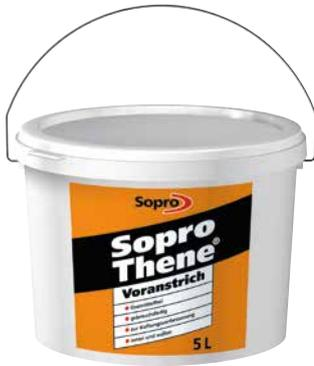
Hochwertiger, schnell trocknender, lösemittelfreier, gebrauchsfertiger Voranstrich auf Bitumen-Kautschukbasis, als Grundierung auf mineralischen Untergründen für nachfolgende Abdichtungen mit SoproThene® Bitumen-Abdichtungsbahn.
